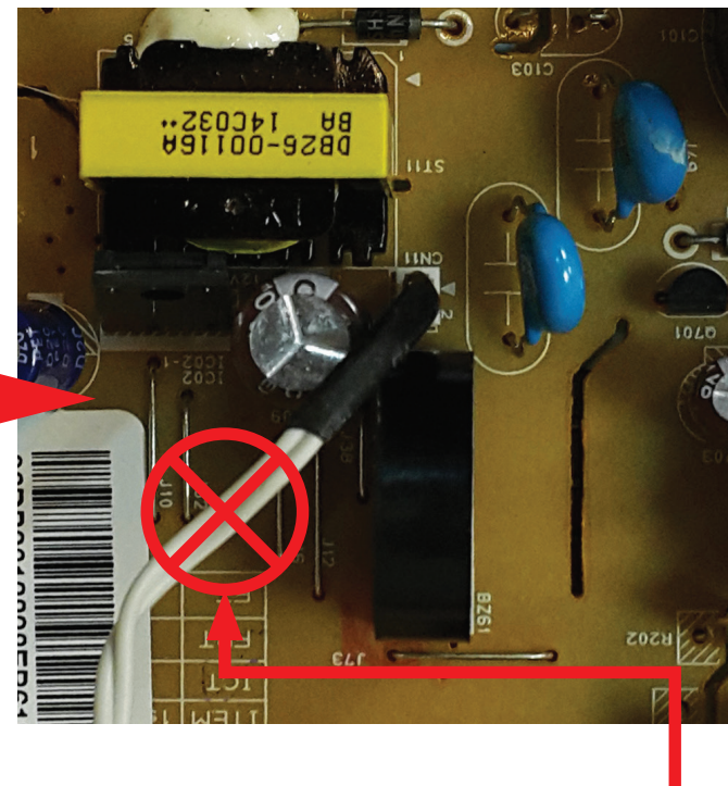
دو سر کابل ترموفیوز، قطع شده و به یکدیگر متصل شود.
